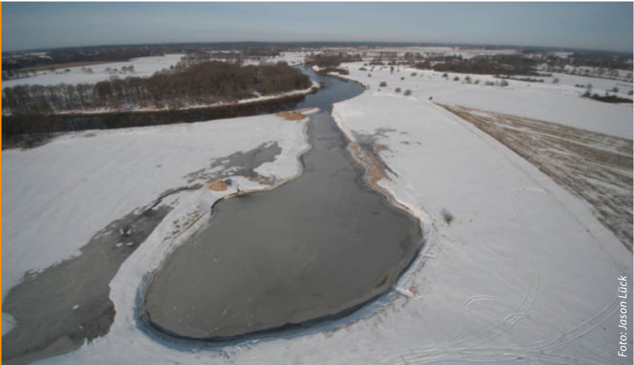
Unterstromig angebundenes Seitengewässer mit Verbindung zur Wasserstraße Ems
